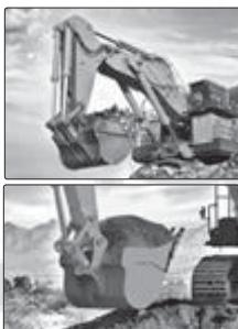
هر باكت حفار از یک باكت، یوم ماشین ( محل نصب باكت حفار)، یک کله حفاری دورانی که در باكت نصب شده، کابین، شاسی، جک‌های هیدرولیکی ماشین برای انتقال نیروی فشاری به باكت حفار و سیستم جابجایی ماشین که اکثرا برای سهولت جابجایی چرخ زنجیری است؛ ساخته شده است.
