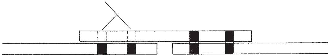
شکل ۹ - ۴۲ - روش سوراخ کردن ورق‌های اتصال.
