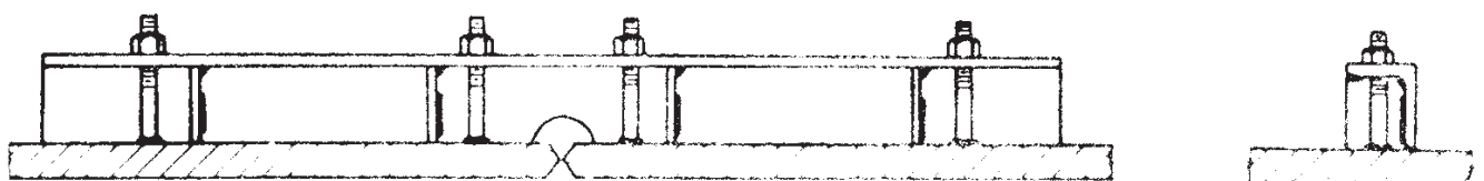
استفاده از پشت‌بند و پیچ و مهره برای هم‌راستایی ورق‌ها
